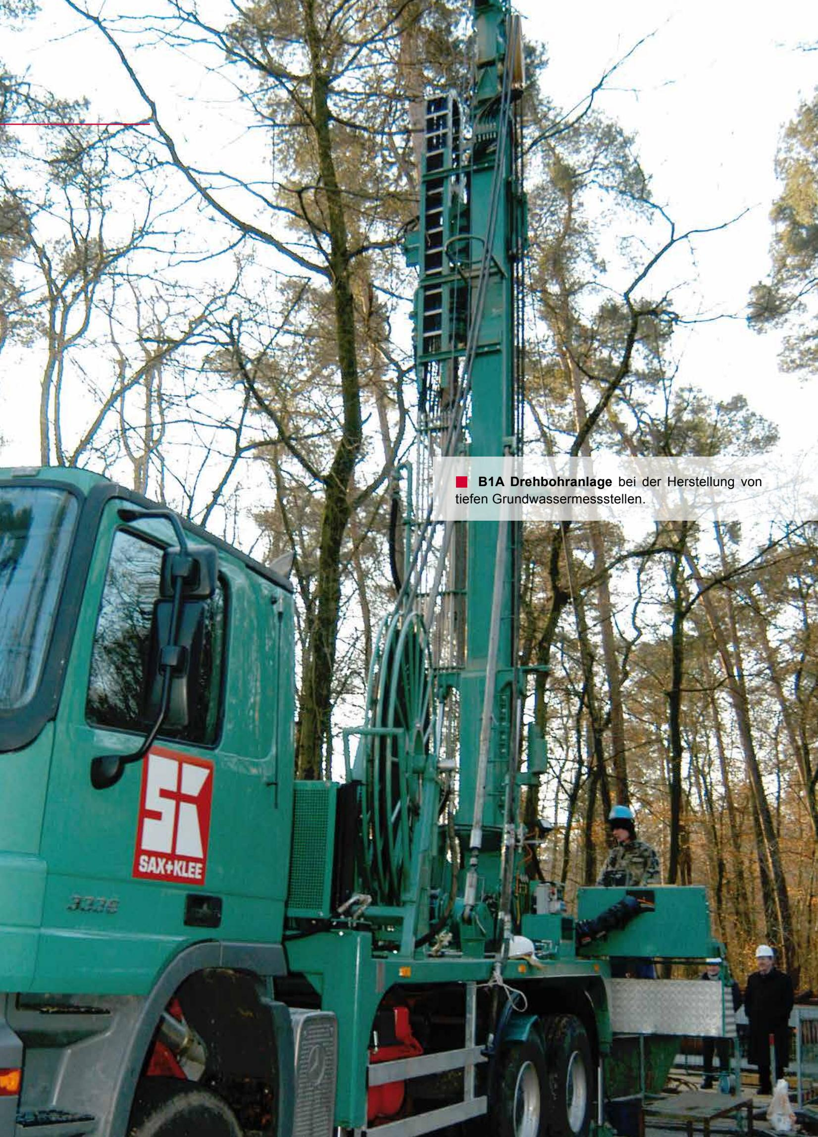
■ **B1A Drehbohranlage** bei der Herstellung von tiefen Grundwassermessstellen.
